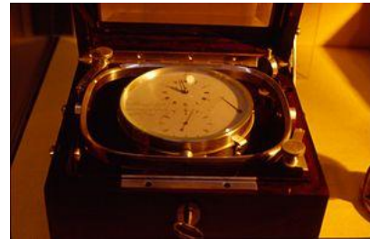
Cronómetro marino montado sobre anillos cardánicos
